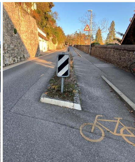
Bypass vélo intégré au rétrécissement horizontal de la chaussée (Neuchâtel)
