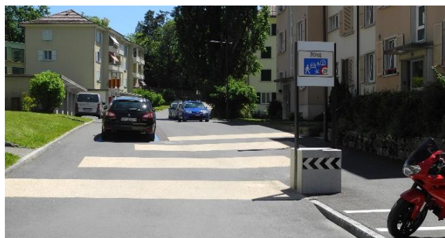
Rehaussement général de la chaussée, stationnement alterné et aménagement de façade à façade (Neuchâtel)
